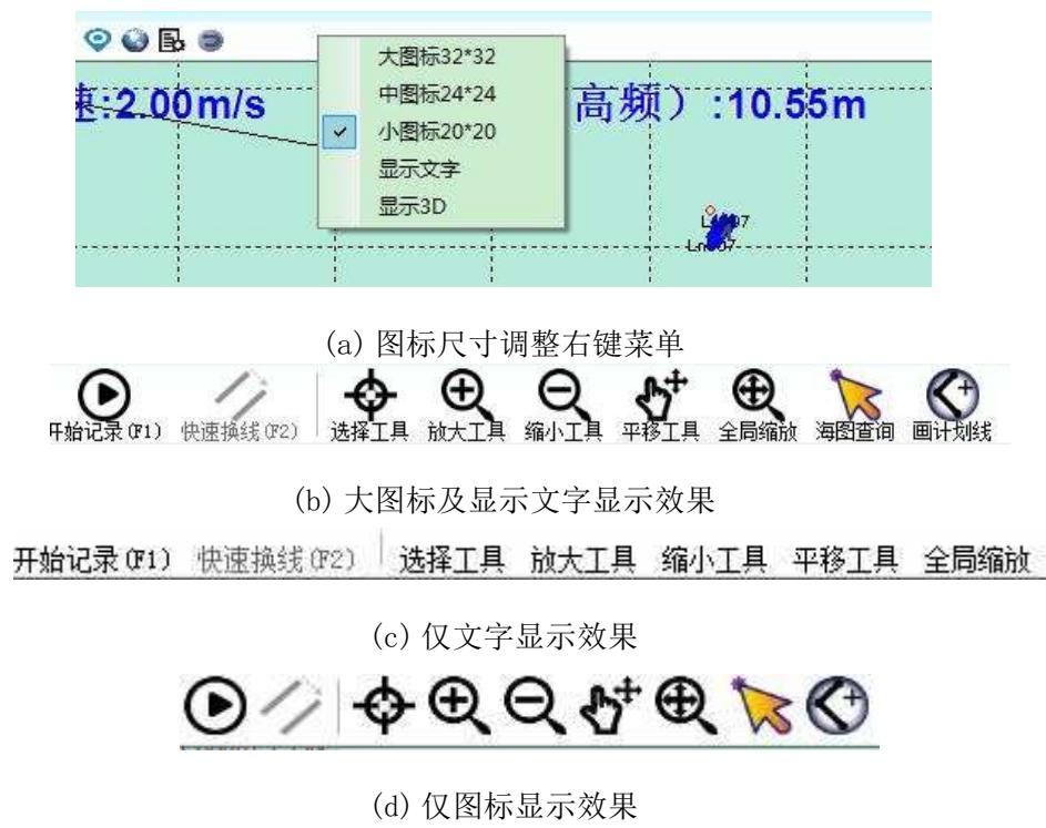
图 10-22 图标尺寸调整及显示效果
