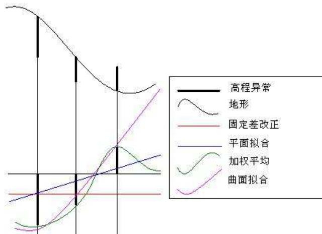
图 4-12 高程拟合平面模拟对比图
