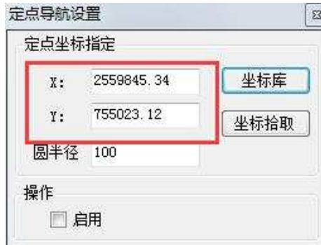
图 10- 17 通过编辑框直接添加导航坐标平面坐标
