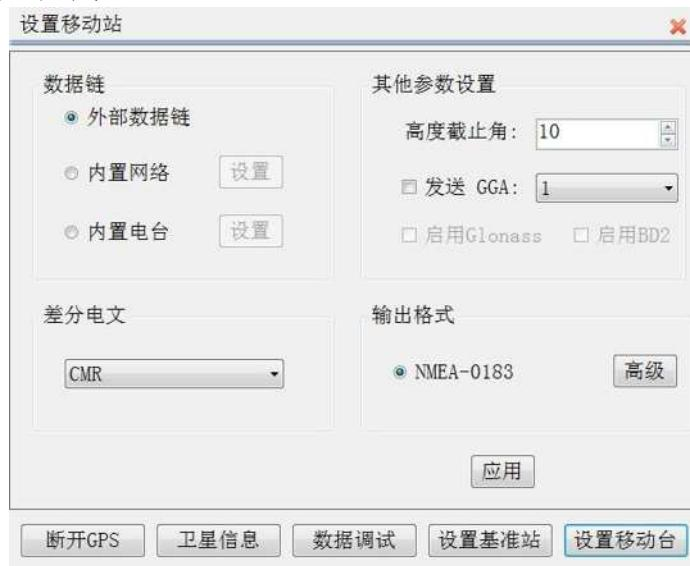
图 15-17 RTK 移动站设置
