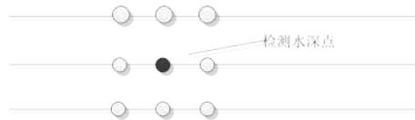
图 11- 16  $3*3$  窗下的统计滤波示意图
