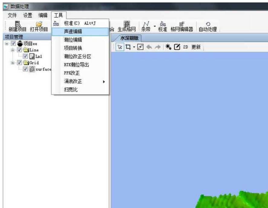
图 14-1 数据处理界面打开声速编辑功能
